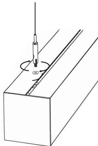
20. Manejando los dispositivos del Racor, deslice la guaya para nivelar la luminaria.
