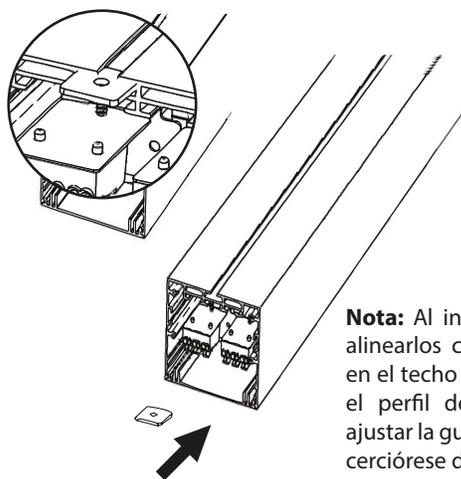
**Nota:** Al instalar los racores recuerde alinearlos con los agujeros realizados en el techo pues el racor se desliza por el perfil de la luminaria. No olvide ajustar la guaya a la distancia deseada y cerciórese de que quede nivelada.
