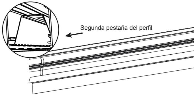
6. Instalar el difusor en el perfil de la mini titania ya instalado.
