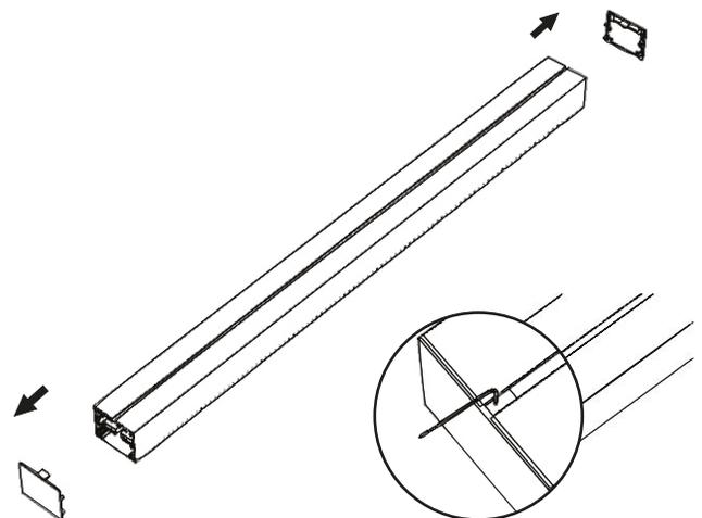
16. Ensamblar el Racor por la canal de la parte superior de la luminaria.
