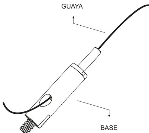
19. Atornillar la base del Racor deslizante titania en el Racor.
