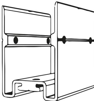
1. Encaje la UNIÓN LÁMPARA MINI TITANIA entre los dos extremos de la luminaria
