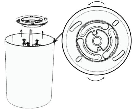
3. Pase el cable de poder por el orificio central del soporte de la luminaria.
