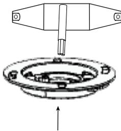
4. Asegure el soporte a la caja octagonal con los tornillos.
