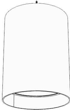
1. Desmontar el soporte de la luminaria con un leve giro hacia la izquierda.
