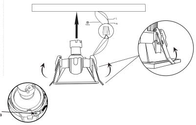
5. Coloque el bombillo juntando los conectores y girar hacia la derecha.
