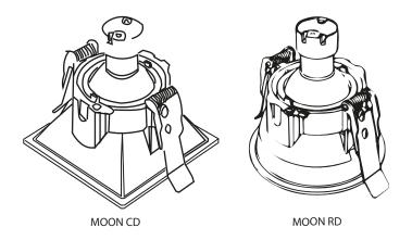
2. Abrir un orificio en el techo de 9.2 cm de área (MOON CD) Abrir un orificio en el techo de 8.9 cm de diámetro (MOON RD)
