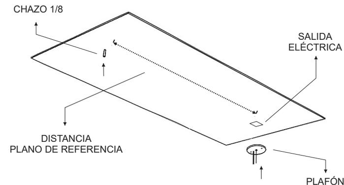
NOTA: Instalar el Plafón del kit de Suspensión en la caja Octagonal o salida Eléctrica de la placa.
