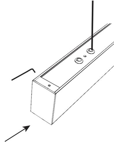
11. Atornillar la base del racor deslizante Titania en el soporte y asegure este con el tornillo racor.
