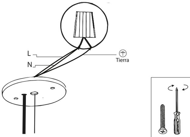
6. Ya instalado el plafón usar chazo al otro extremo del orificio para colocar la guaya.
