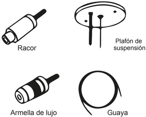
4. instale el plafón en el techo, pase el cableado y la guaya por los orificio indicados.
