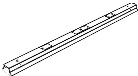
2. Ubique la salida eléctrica en el techo, abra dos orificios a una distancia de 604 mm del otro.
