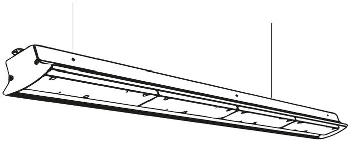
2. Ubique la salida eléctrica en el techo, abra dos orificios a una distancia de 604 mm del otro.
