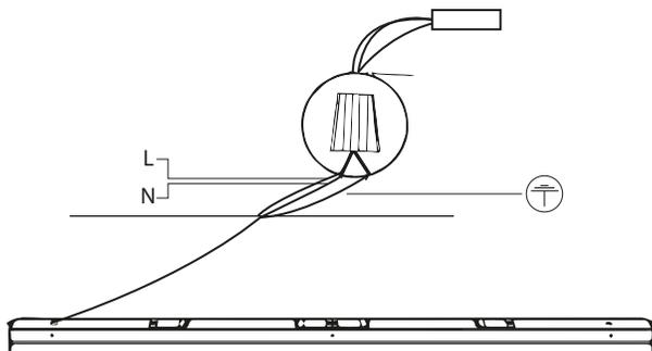
4. Coloque la luminaria en el techo y ajústela con dos tornillos con chazos.
