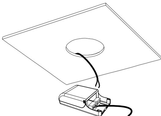
3. Coloque el driver sobre el techo falso y conecte la luminaria.
