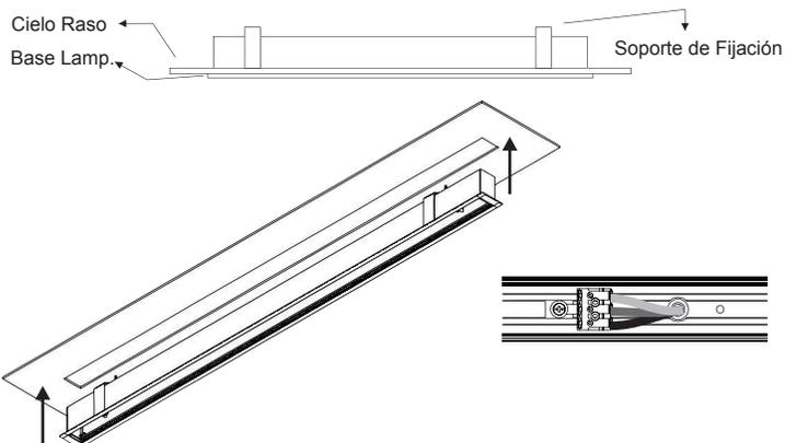
5. Ajustar el Tornillo para hacer girar y sujetar los Soportes de Fijación.
