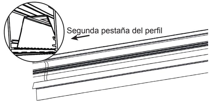
8. Instalar el difusor en el perfil de la luminaria ya instalado.
