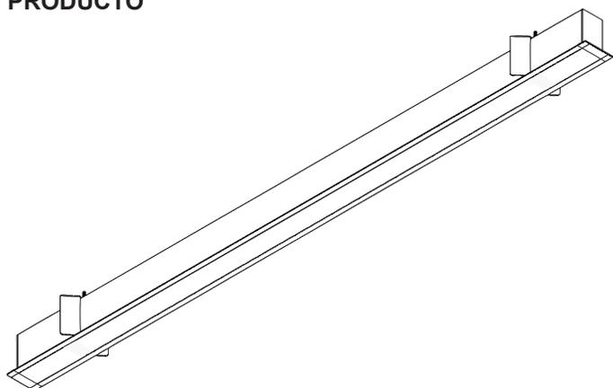
1. Retirar el difusor deslizando una tarjeta entre el borde de este y el chasis de la luminaria.
