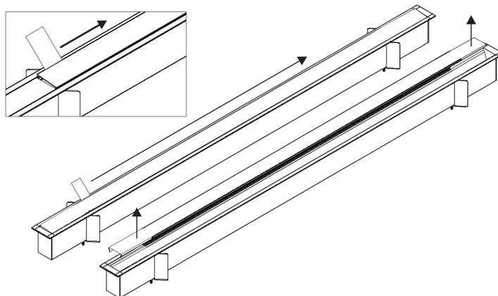
2. Retire el reflector de la luminaria empujando levemente primero uno de los costados y posteriormente el otro hacia el fondo.
