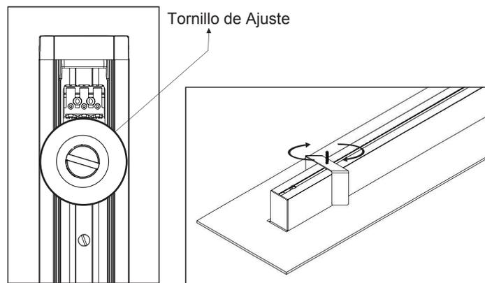
Nota: Los soportes de Fijación giraran parcialmente hasta quedar sujetos a la Luminaria, mientras el tornillo sigue girando para asegurarlas.
