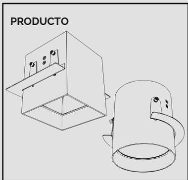
1. Abrir un orificio en el techo de 103mm de área (cuadrada) o 109mm de diámetro (redonda)
