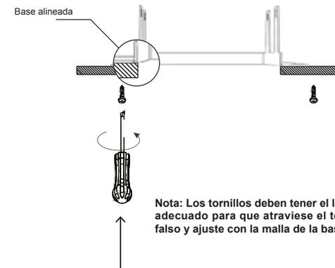
**Nota:** Los tornillos deben tener el largo adecuado para que atraviese el techo falso y ajuste con la malla de la base.
