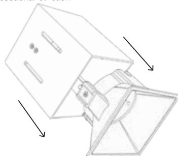
5. Introduzca el cuerpo en el agujero de la base y ajuste levemente los tornillos cabeza de botón con ayuda de la llave bristol, ubique la luminaria a la altura deseada y termine de ajustar los tornillos
