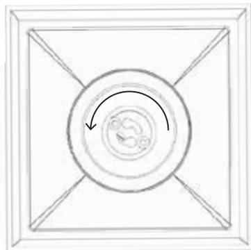
8. Ensamblar la bombilla base GU10 / 120V en el socket de la bala
