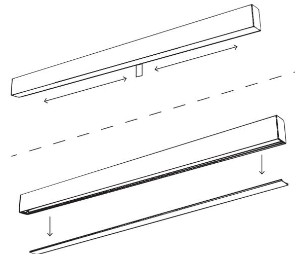
3. Desmonte el perfil reflector utilizando destornillador pala y aflojandolo suavente del disipador por las pestañas.
