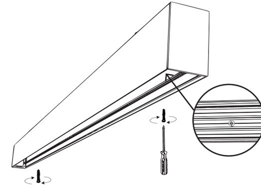
7. Coloque el perfil reflector asegurandolo de las pestañas.
