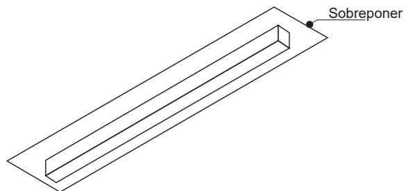
2. Desmontar el difusor utilizando una tarjeta por uno de los bordes y despues retirar el difusor.
