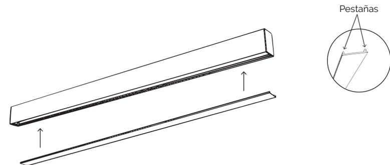
**Nota:** para ingresar el reflector se debe inclinar e ingresar primero por un costado y posteriormente por el otro.
