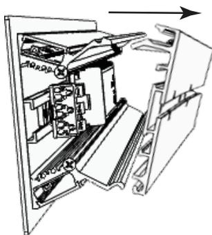
3. Introduzca los cables de la fuente de energía por el "pasa cable siliconado" y realice su respectiva conexión a la clema
