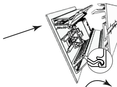
**Nota:** Una vez encajado el perfil empuje le cuerpo de la luminaria sobre el soporte el sonido de un "click" indica que la luminaria quedo asegurada y soportada.
