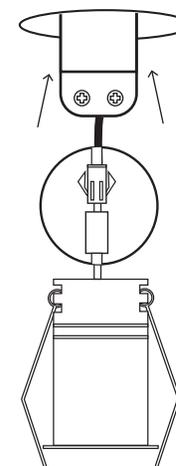
5. Coloque la luminaria en la abertura, levantando los resortes de sujeción, de manera tal que quede en posición vertical.
