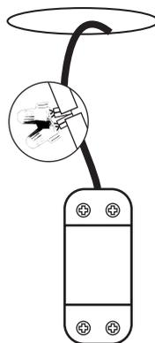
4. Ingrese el driver por el orificio y conecte el conector macho del driver con el conector hembra de la luminaria.
