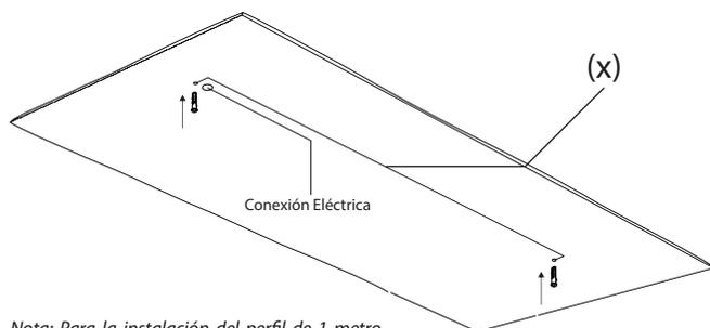
*Nota: Para la instalación del perfil de 1 metro tome una distancia de 20mm en cada esquina. Para la instalación de 2 metros en adelante realice perforaciones cada 1134mm.*
