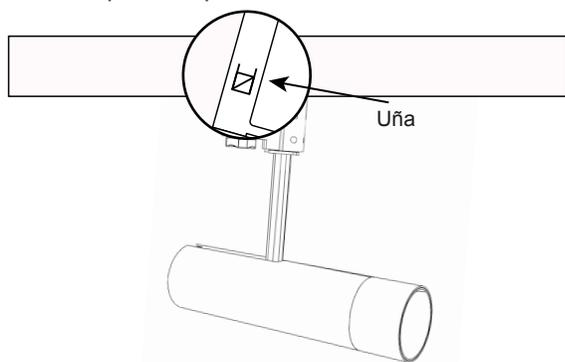
5. Asegure el soporte al riel girando la palanca hacia el centro de la luminaria.
