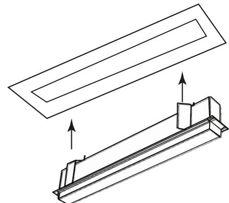
7. Ajustar el Tornillo para hacer girar y sujetar los Soportes
