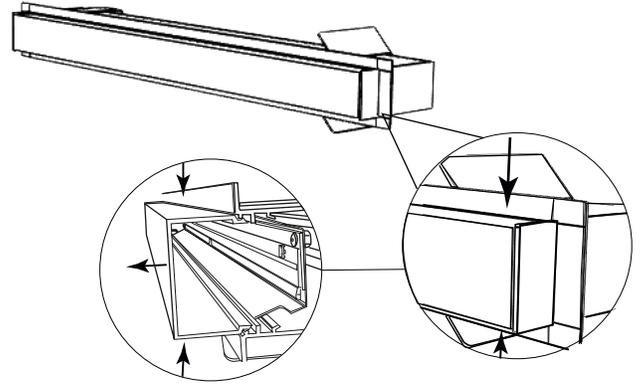
3. Retirar el reflector deslizando una tarjeta y halando.
