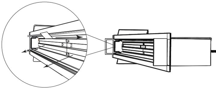
4. Realizar perforación en cielo raso o lugar de instalación de 585mm x 61mm
