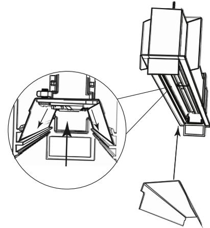
9. Instalar el difusor en el perfil de la luminaria ya instalado.
